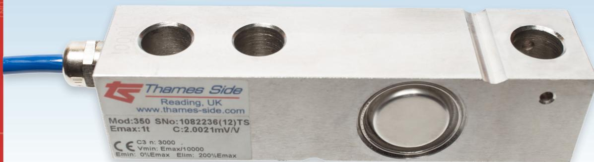
Diese Edelstahl-Scherkraftwägezelle ist hermetisch verschweißt, mit Schutzklasse IP68/IP69K, so dass sie in härtesten Industrieumgebungen verwendet werden kann. Anwendung findet sie typischerweise in Plattformwaagen, Tank- und Behälterverwiegungen, Big-Bag Füllmaschinen und Förderanlagen. Die 350i ist nach OIML R60 3000d zugelassen und der Ausgang wird in mV/V/Ω kalibriert – was die Zeit zum Eckenlastabgleich bei Plattformwaagen minimiert.
