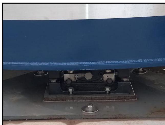
Fig. 4 – Célula de carga VC3500 dentro do acessório de montagem patentado MasterMount®
