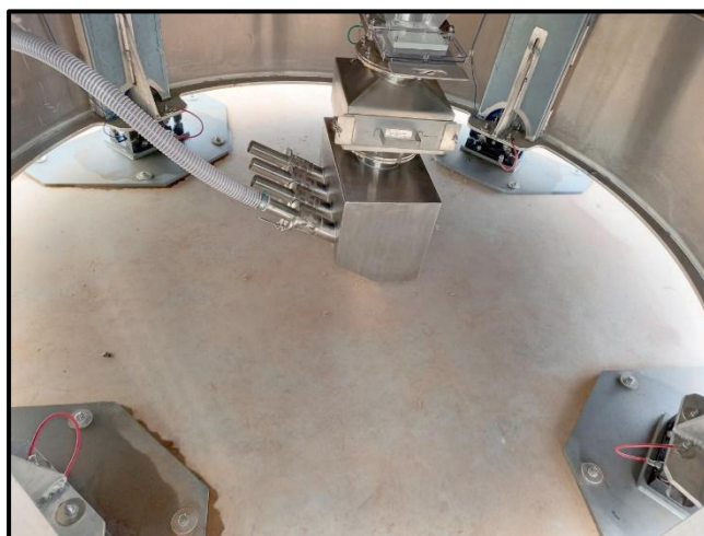
Fig. 2 - Sistema de descarga por transporte pneumático
