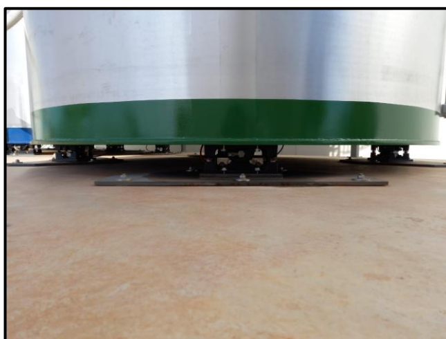
Fig. 3 – Sistema de Pesagem "MasterMount®"
