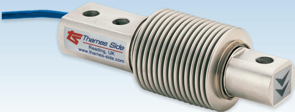
Diese voll verschweißte Biegebalkenwägezelle aus Edelstahl ist hermetisch dicht mit Schutzklasse IP68 / IP69K und kann in härtester Industrieumgebung eingesetzt werden. Einsatzgebiete sind Wiegeplatten, Sackfüller, Bandwaagen und Tankverwiegung in der Lebensmittel-, Chemischen-, Pharmazeutischen- und allgemeinen Warenverkehr Industrie.
